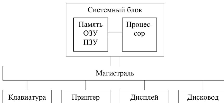
Рис. 2. Функциональная схема ЭВМ
