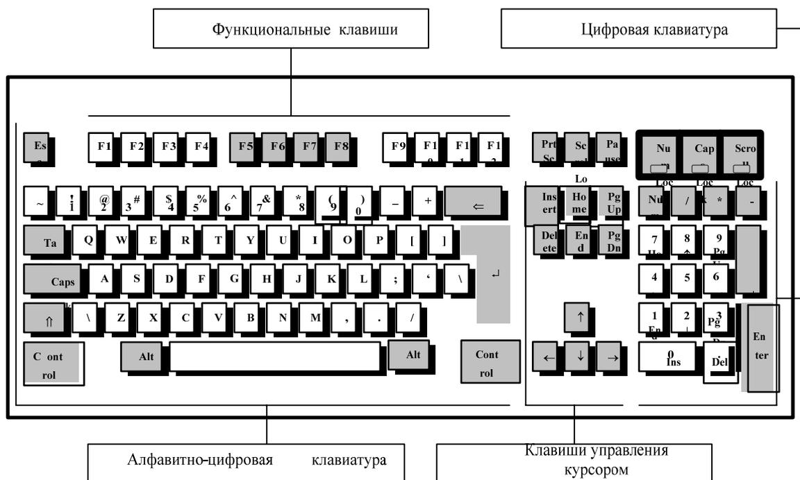
Рис. 8. Клавиатура компьютера IBM PC (модель клавиатуры для IBM PC AT)
